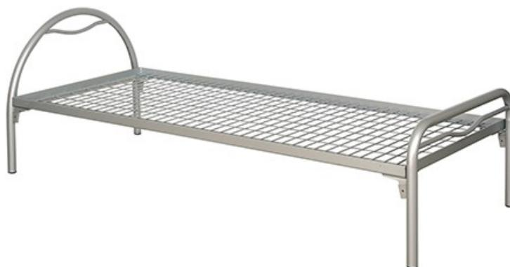
Lit tout métal avec sommier métal. 2 montants en tube acier Ø 40 x 1.5 (tête et pied de lit identiques). 4 embouts ? 40 en polypropylène, non tachants. La tête et le pied de lit sont munis de supports de cadre sommier en feuillard acier 50 x 1.5mm, soudés sur les pieds. Blocage par 4 vis M6 + écrous borgnes. Revêtement poudre thermodurcissable à base d'époxy et de polyester. Coloris au choix nous consulter. Garantie 2 ans.
