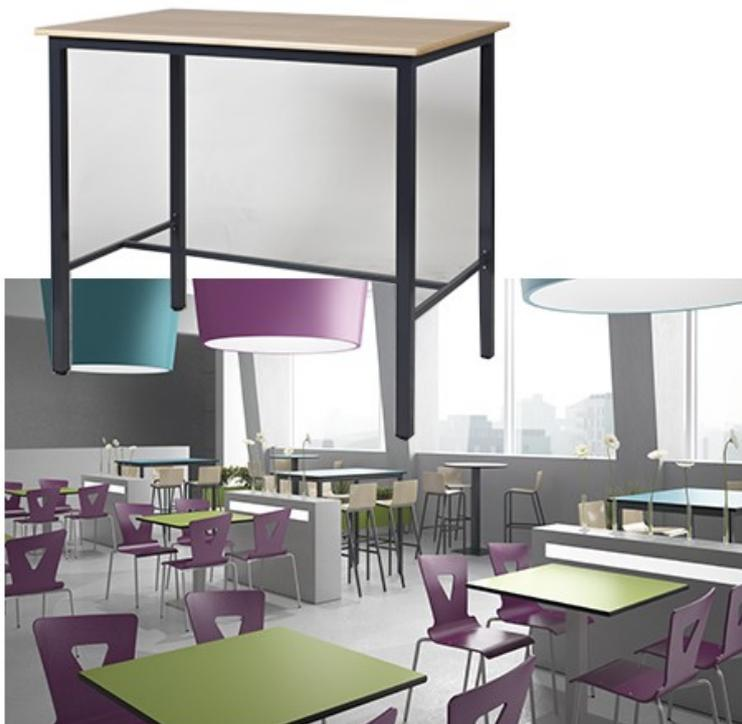
Plateau stratifié épaisseur 22 mm, chants surmoulés : haute résistance. Iétement acier. Montants et traverses tube 40 X 40 mm. Repose pieds tube acier 20 X 20 mm. Embouts avec vérins de réglage en polyéthylène. Hauteur 110 cm.
