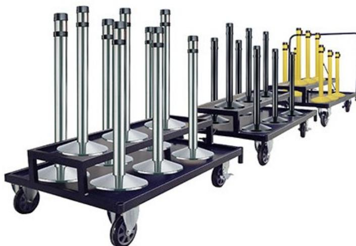
Chariot de transport pour tous les types de poteaux (corde, sangle et base de diamètre 50 à 80 mm). Munis d'un tapis antidérapant et d'une poignée ergonomique, il vous permettra de ranger proprement vos poteaux. Il possède également 2 roues rotatives avec freins ainsi que 2 fixes. Il se raccorde au chariot de départ. Poids : 34 kg. Dims (en cm) : L90 x P81 x H11.
