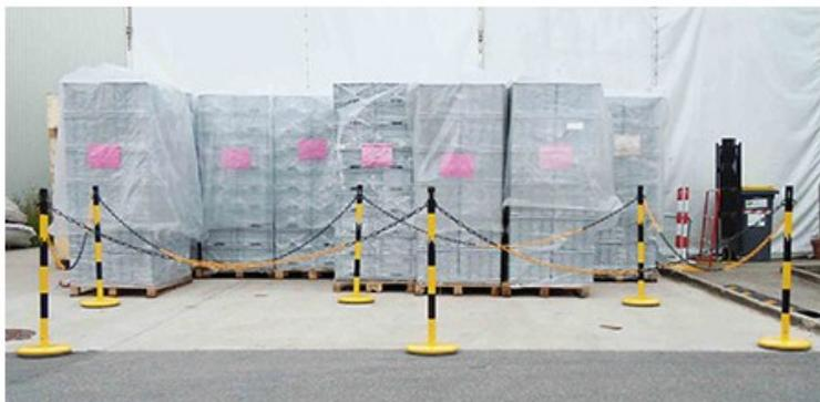
Kit comprenant : 6 poteaux en acier noir et jaune de diam Ø 50 mm, 15 m de chaine, 12 crochets. Dim poteau (cm) : Ø 5 x H 100. Dim base (cm) : Ø 33.
