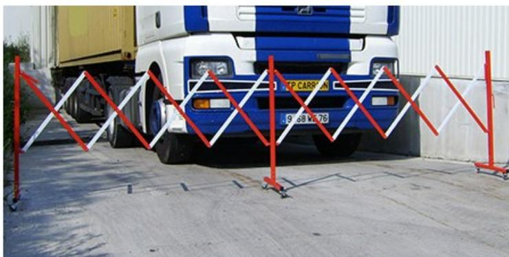
Barrière en acier, extensible jusqu'à 4 mètres. Finition coloris blanc et rouge. 6 Roulettes avec frein de diamètre 50mm. Dim (cm) : L 400 x P 45 x H 94. Poids 15 kg.
