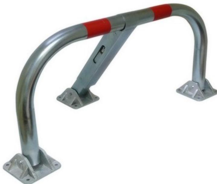
Barrière de parking avec clés identiques. Tube en acier de diamètre 60 mm, épaisseur 20/10ème. Pied en fonte , fixation béton incluse. Verrouillage automatique. Dim (cm) : L 96 x P 42.5 x H 45.5. poids 12.5 kg.
