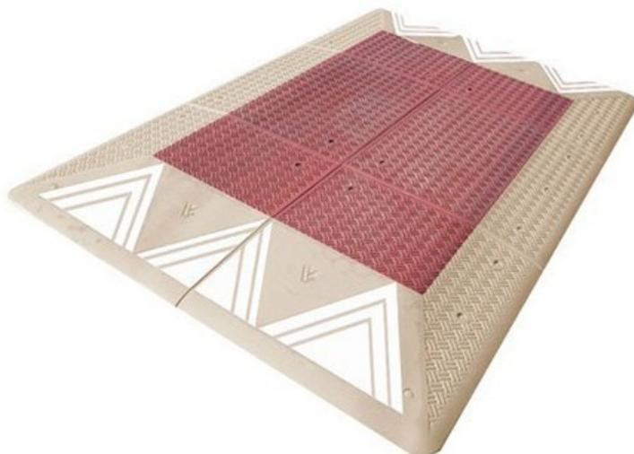
Coussin berlinois certifié CERTU SRT 0.65. Composé de 6 éléments avec 4 réflecteurs, dents de requin réfléchissantes 3M. Fixations et liaisons incluses. Finition caoutchouc vierge vulcanisé, coloris beige et rouge. Dim (cm) : L 300 x P 180 x H 6.5. Poids 360 kg.
