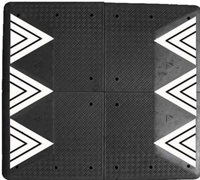
Coussin berlinois certifié CERTU SRT 0.65. Composé de 4 éléments avec 4 réflecteurs, dents de requin réfléchissantes 3M. Fixations et liaisons incluses. Finition caoutchouc vierge vulcanisé, coloris noir. Dim (cm) : L 200 x P 180 x H 6.5. Poids 240 kg.
