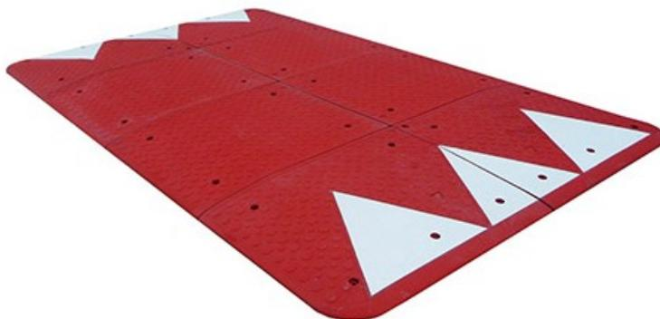
Coussin berlinois certifié CERTU SRT 0.65. Composé de 6 éléments avec 4 réflecteurs, dents de requin réfléchissantes 3M. Fixations et liaisons incluses. Finition caoutchouc vierge vulcanisé, coloris rouge. Dim (cm) : L 225 x P 180 x H 6.5. Poids 268 kg.
