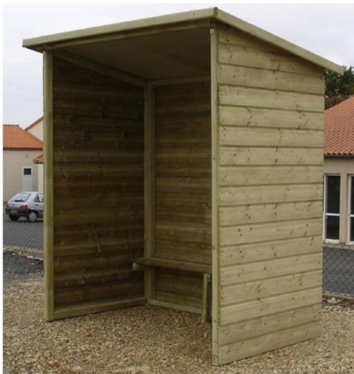
Structure bois sans fenêtre, essence pin nord rouge Finlande, catégorie 5, gage de stabilité et de haute résistance. Traitement autoclave classe III, sans chrome ni arsenic. Bardage en clin plat ép. 21 mm sur cadre. Toit en tôle acier laqué. Banc sur toute la longueur. Dim. L200cm x P120cm x H210cm. Poids : 274 kg. Livré pré-monté à sceller. Visserie INOX A2 pour l'assemblage des bois. Equerres de scellement 90\*90\*65cm en acier zingué.
