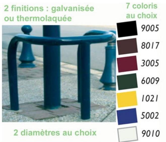
Etriers de protection spécialement conçus pour protéger le tronc des arbres, les mâts et candélabres, les supports de panneaux, les bornes incendie. A sceller. Fabrication en acier galvanisé à chaud (+,- 80 microns), apportant une protection remarquable. Peinture thermolaquée selon RAL. Hauteur totale 80 cm. Ouverture 60 cm.
