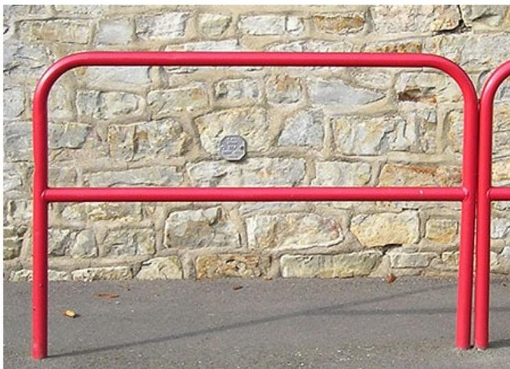
Arceau renforcé avec corps en tube acier de diam 60. Thermolaqué, coloris au choix nous consulter. DIM (cm) : L 100 x H 120, Hors sol 90 cm, scellement 30 cm. Poids 12 kg.
