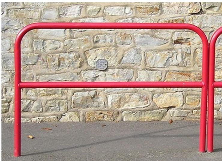
Arceau renforcé galvanisé à chaud avec corps en tube acier de diam 60. DIM (cm) : L 200 x H 120, Hors sol 90 cm, scellement 30 cm. Poids 18 kg.
