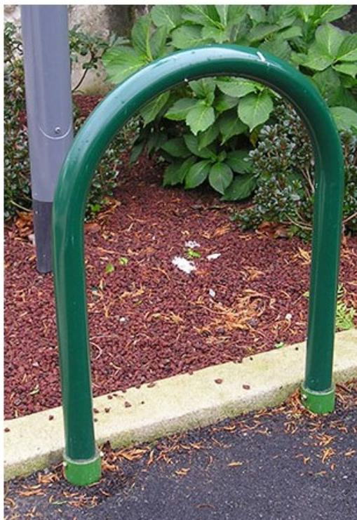
Epingle de protection avec corps en tube acier de diam 60. Thermolaqué, coloris au choix nous consulter. DIM (cm) : L 60 x H 90, Hors sol 60 cm, scellement 30 cm. Poids 6 kg.
