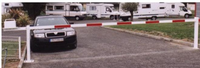
Conception : Poteaux de soutien et de réception en fûts métalliques de 80 X 40 X 2 mm galvanisés. Platine épaisseur 10 mm avec tiges de scellement. Flèche aluminium laqué 80 X 80 mm avec bandes rétroréfléchissantes rouges. Contrepoids intégré dans un coffret sur la flèche. Blocage du bras en position horizontale ou verticale par goupille traversante. Fermeture par cadenas fourni. Finition : laque blanche polyuréthane (cuite au four). Livrée avec notice de montage.
