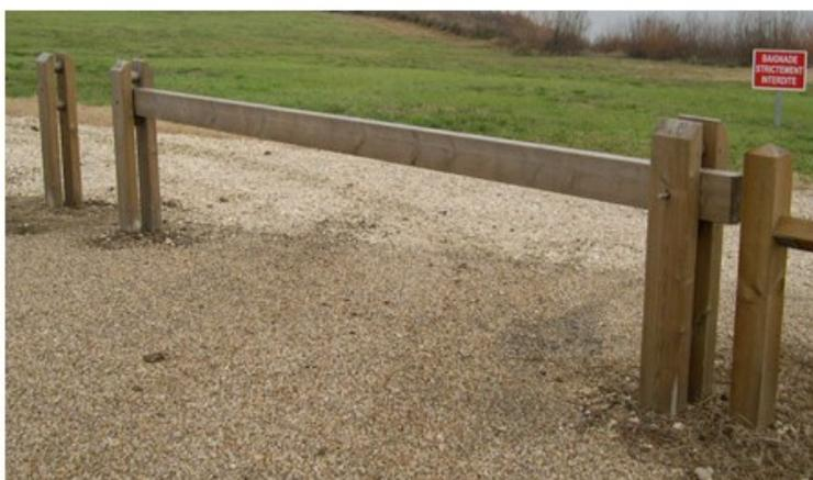
3 pieds formés de 2 poteaux assemblés avec 2 rondins de bois exotiques permettant un glissement sans effort de la lisse. Lisse et piétement en bois rabotés autoclave classe IV. Lisse section 17 X 7 X L 400 cm. Hauteur 90 cm.
