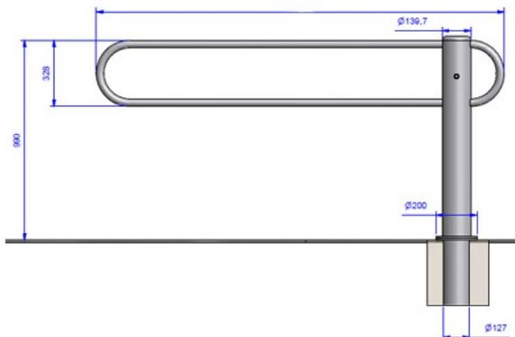
Barrières économiques, robustes et très pratiques pour contrôler l'accès de vos zones piétonnes. Fabriquées en acier galvanisé, finition peinture thermolaquée. Blocage à 90°. Fermeture avec goupille et cadenas avec clé triangle (fournis). Fût central  $\varnothing 139,7$  mm, base diamètre 200 mm. Epingle tube  $\varnothing 38$  mm, hauteur 32,8 cm. Equipées d'un système anti-dégondage. A sceller. Hauteur totale 99 cm. Longueurs 200 cm.
