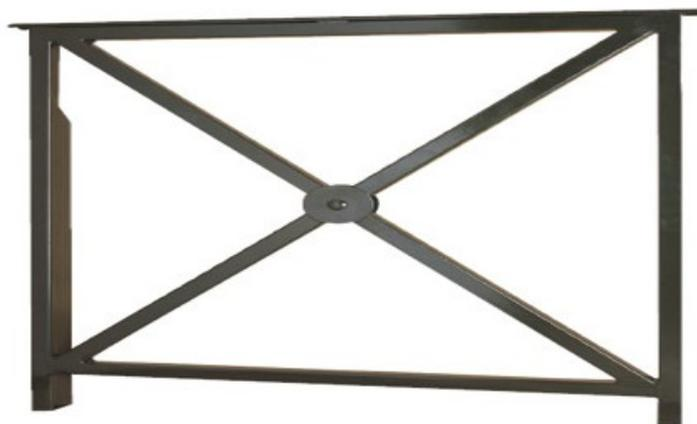
Barrière fixe à sceller. Hauteur hors sol : 0,90 m. Hauteur totale : 1,13 m. Longueur 2 m. Main courante en acier moulé de 40 X 10,5 mm. Montants latéraux, lisses et croix : tube carré de 30 X 30 X 2 mm. Renfort : tube rectangle de 60 X 30 X 2 mm. Motif central : macaron diam. 76 mm / épaisseur 2 mm / Rivet diam. 20 mm. (dessus du macaron obstrué par une tôle en acier soudé).
