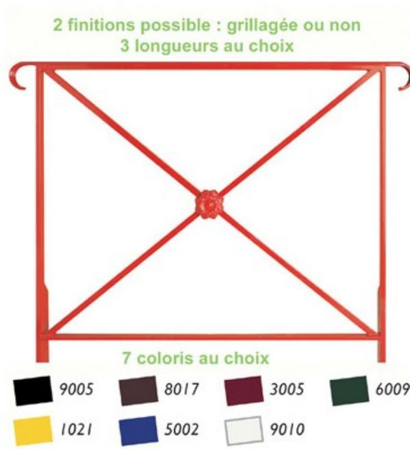
En acier galvanisé à chaud (+,- 80 microns), lui apportant une protection remarquable. Coloration obtenue par thermolaquage (poudre polyester cuite au four), isolant et décoratif. Barrière fixe à sceller. Hauteur hors sol : 0,91 m. Hauteur totale : 1,15 m. Main courante en acier moulé de 40 X 10,5 mm, avec crosses. Montants latéraux et renforts : fer plat 30 X 12 mm. Croix : fer plat de 18 X 18 mm. Macaron : rosace en fonte soudée.
