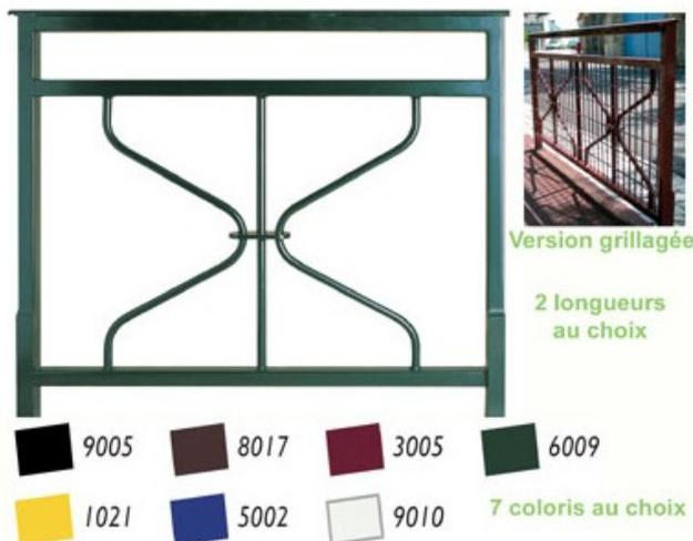
En acier galvanisé à chaud (+,- 80 microns), lui apportant une protection remarquable. Coloration obtenue par thermolaquage (poudre polyester cuite au four), isolant et décoratif. Barrière fixe à sceller. Hauteur hors sol : 0,90 m. Hauteur totale : 1,13 m. Main courante en acier moulé de 40 X 10,5 mm. Montants latéraux et lisses : tube carré de 35 X 35 X 2 mm. Renfort : fer plat 35 X 12 mm. Barreaudage : tube rond Diam. 18 X 1,5 mm. Motif central : fer plat de 50 X 10 mm.
