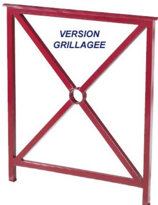
Barrière fixe à sceller. Hauteur hors sol : 0,90 m. Hauteur totale : 1,20 m. Main courante en acier moulé de 40 X 10,5 mm. Montants latéraux, lisses et croix : tube carré de 30 X 30 X 2 mm. Anneau central de 76,1 X 5 mm. 2 longueurs au choix : 84 ou 150 cm. Pour le modèle grillagé : treillis soudé, maille de 50 X 100 mm, fil diamètre 5 mm.
