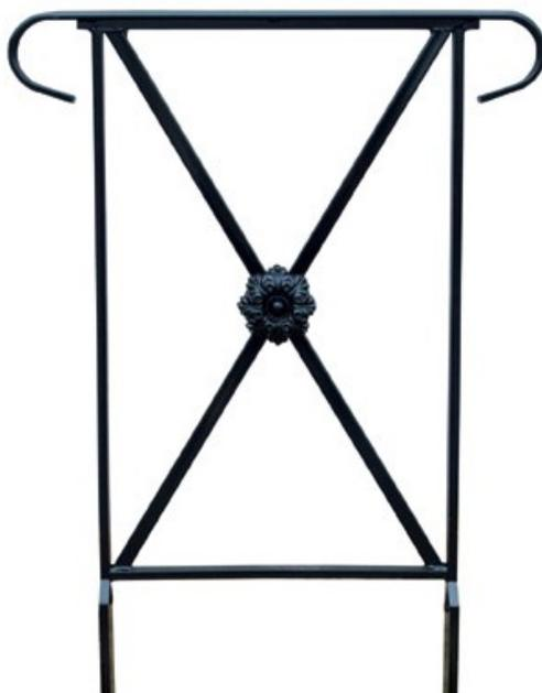
Barrières Cadre en fer plat de 30 X 12 mm. Main courante moulurée en acier massif de 40 X 10 mm, avec renfort carré plein 18 X 18 mm. Croix en tube 20 X 20 X 1,5 mm. Renfort de pieds. Finition : peinture laquée noire.
