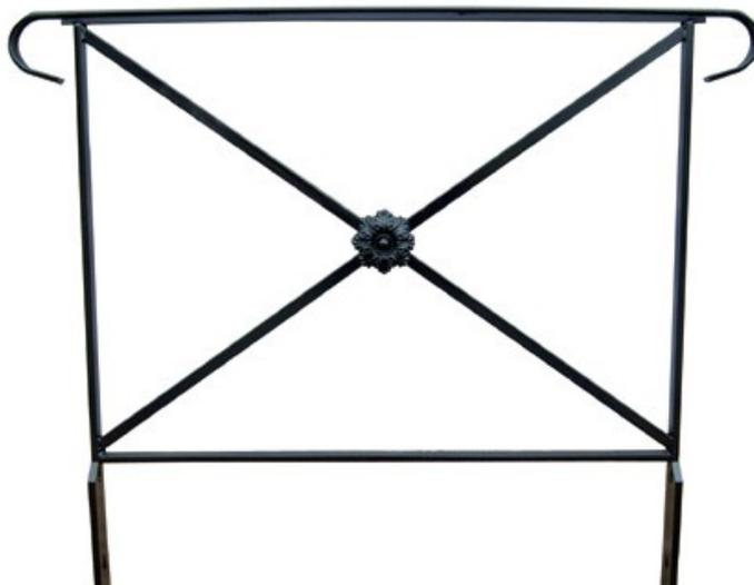
Barrières Cadre en fer plat de 30 X 12 mm. Main courante moulurée en acier massif de 40 X 10 mm, avec renfort carré plein 18 X 18 mm. Croix en tube 20 X 20 X 1,5 mm. Renfort de pieds. Finition : peinture laquée noire.
