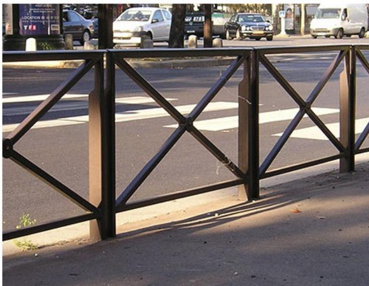
Barrière avec main courante en demi-rond de 40 x 10 mm biseauté aux extrémités. Montants en tube de 30x30 mm avec renfort de 60x30 mm. Lisse et croix en tube de 30x30 mm. Macaron de diam 75 mm sur chaque côté. Thermolaqué, coloris au choix nous consulter. DIM (cm) : L 84 x H 113, Hors sol 90 cm, scellement 23 cm. Poids 13.5 kg.
