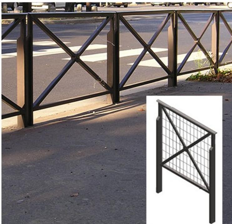
Barrière grillagée avec main courante en demi-rond de 40 x 10 mm biseauté aux extrémités. Montants en tube de 30x30 mm avec renfort de 60x30 mm. Lisse et crois en tube de 30x30 mm. Macaron de diam 75 mm sur chaque côté. Treillis 100 x 50 mm. Thermolaqué, coloris au choix nous consulter. DIM (cm) : L 164 x H 113, Hors sol 90 cm, scellement 23 cm. Poids 21,5 kg.
