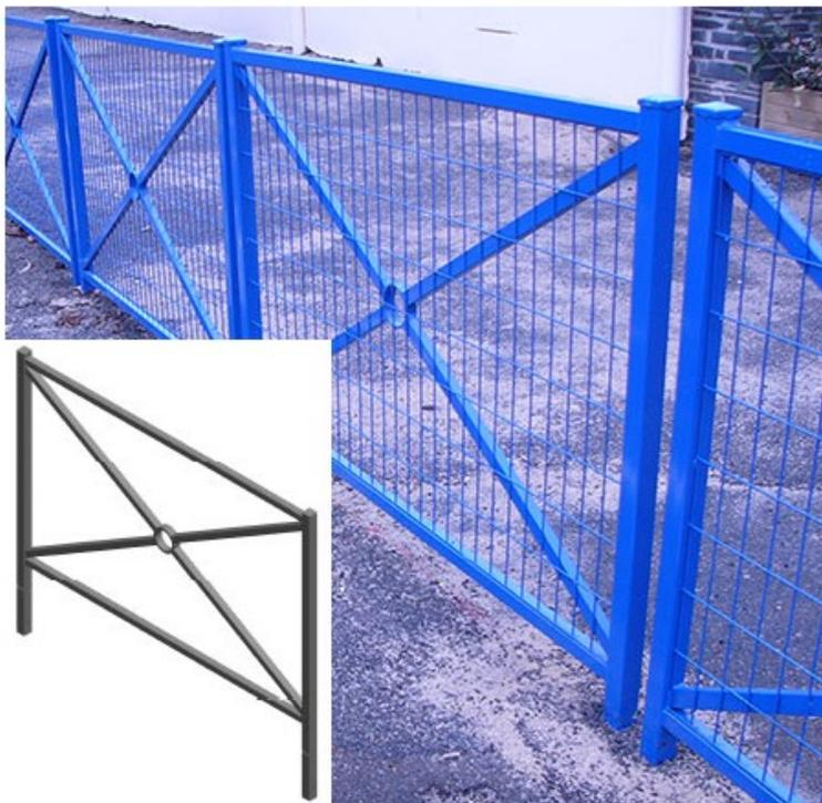
Montant en tube de 40x40 mm. Lisse et croix en tube de 30x30 mm. Anneau centrale de diam 102 mm. Thermolaqué, coloris nous consulter. DIM (cm) : L 146 x H 123, Hors sol 100 cm, scellement 23 cm. Poids 15.5 kg. Option : kit d'amovibilité.
