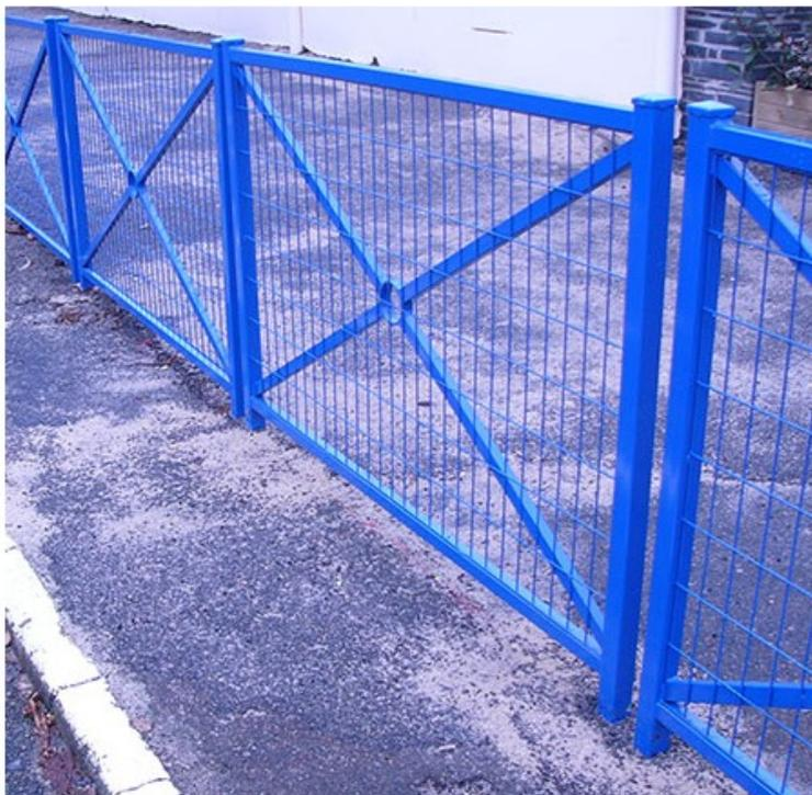
Montant en tube de 40x40. Lisse en tube de 30x30. Croix en tube de 30x20. Treillis 100 x 50. Anneau centrale de diam 102. Thermolaqué, coloris nous consulter. DIM (cm) : L 146 x H 123, Hors sol 100 cm, scellement 23 cm. Poids 16 kg. Option : kit d'amovibilité.
