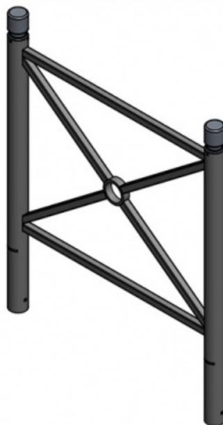
Montants en tube de diamètre 76 mm. Lisse et croix en tube de 30x30 mm. Anneau centrale de diamètre 102 mm. Thermolaquée, coloris au choix nous consulter. Dim (cm) : L 157.1 x H 130, Hors sol 100 cm, scellement 30 cm. Poids 21 kg. Option : Kit d'amovibilité.
