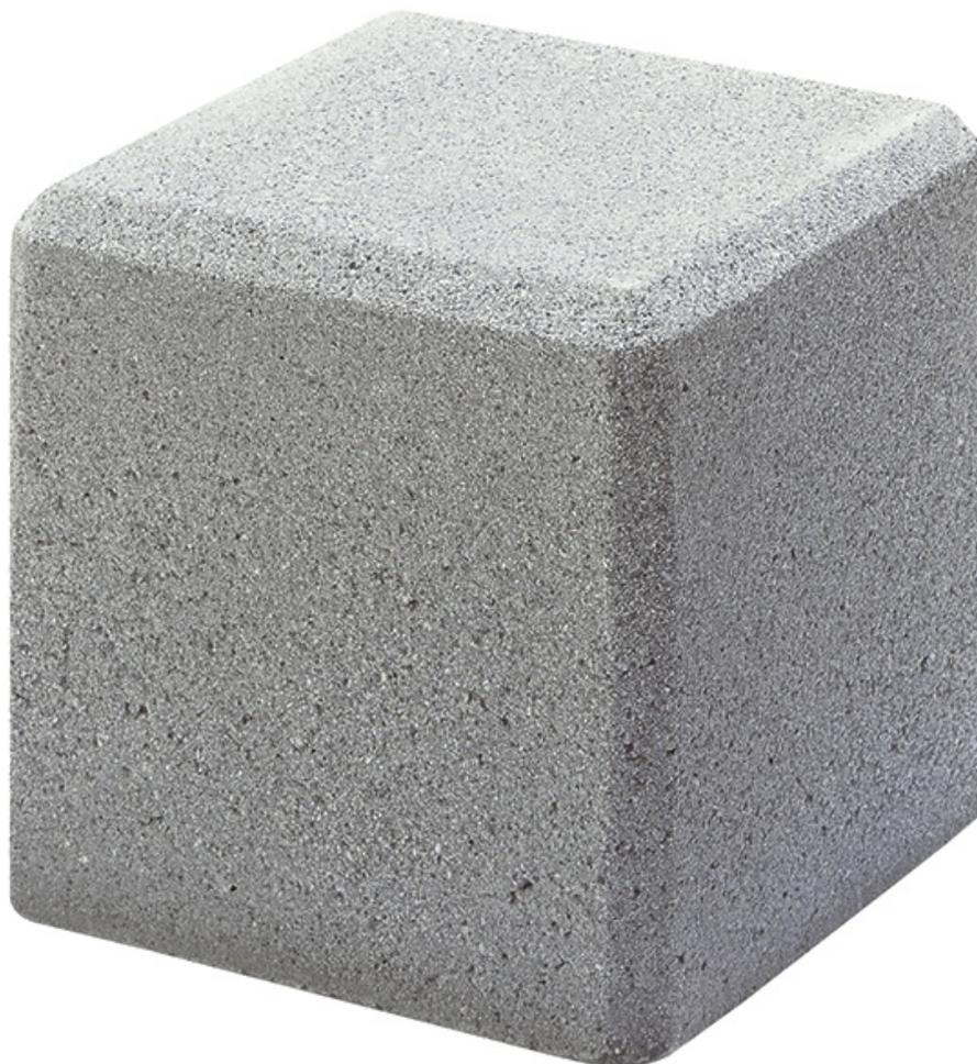
Fabriquée en béton de haute qualité : résistance au gel : 25 cycles de gel (-25degrés C) avec dégel (+15degrés C), sans observer de fissures, de laminations, ou d'exfoliations. Coloris : gris. Autres coloris, nous consulter. Possibilité de traitement anti-graffitis par film protecteur : plus-value de 10 .poids 102 kg
