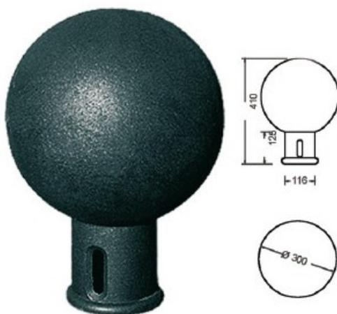
Bornes en fonte FGL 250 traitée anti-oxydant. Finition standard : oxyron peinture noire anti-oxydante. A partir de 30 pièces 5 RAL au choix, en option : Ral 3004 - 5010 - 9005 - 8017 - 6005 (autres RAL sur devis, nous consulter). Toutes ces bornes sont à sceller. Certaines existent avec un système d'amovibilité avec clé triangle.
