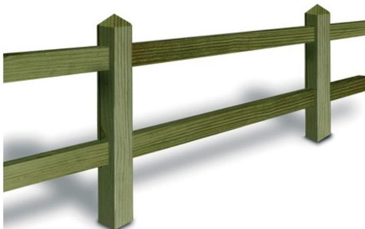
Fabriquée en pin traité en autoclave classe IV sans chrome ni arsenic. Poteaux départ, intermédiaire et d'angle (90 degrés), section 100 X 100 mm. Longueur des poteaux : version 2 lisse 150 cm. Finition pointe de diamant. Assemblage par mortaise. Entraxe poteau 2 m.
