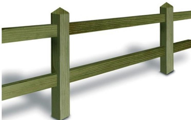
Fabriquée en pin traité en autoclave classe IV sans chrome ni arsenic. Lisse section 120 X 35 mm X L 200 cm. Assemblage par mortaise. Entraxe poteau 2 m.
