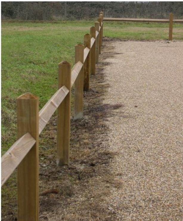
Fabriquée en pin traité en autoclave classe IV sans chrome ni arsenic. Poteau de section 12 X 12 X L 150 cm. Finition pointe de diamant. Lisse en losange.
