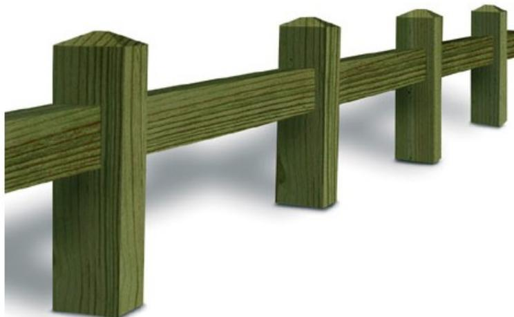
Fabriquée en pin traité en autoclave classe IV sans chrome ni arsenic. Lisse section 120 X 35 mm X L 200 cm. Poteaux départ, intermédiaire et d'angle (90 degrés), section 100 X 100 mm. Longueur des poteaux : 1 lisse L100 cm. Finition pointe de diamant. Assemblage par mortaise. Entraxe poteau 2 m.
