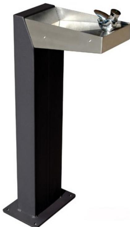
Une fontaine de haute qualité, adaptée pour les enfants et les personnes à mobilité réduite. Fabriquée en acier, finition peinture noire sur couche anti-oxydante. Equipée d'un robinet et bac en inox. 1 robinet en laiton chromé temporisé à jet vertical pour s'adapter aux fauteuils roulants et à hauteur des enfants, hauteur 97,3 cm. Fixation par scellement. Dims (cm) : L44,7 X P30. Poids : 23 kg.
