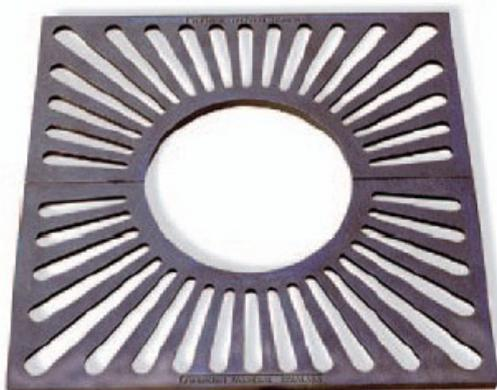
Fonte FGL 250. Finition peinture noire sur couche anti-oxydante. 2 éléments. 80 X 80. En option, cadre acier de support de grille.
