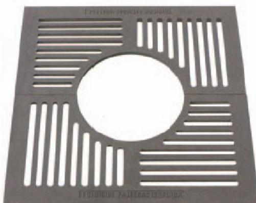
Fonte FGL 250. Finition peinture noire sur couche anti-oxydante. 2 éléments. Dimensions : 100 X 100 cm. En option cadre acier de support de grille.
