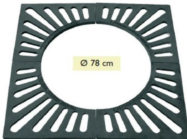
Fonte FGL 250. Finition peinture noire sur couche anti-oxydante. 4 éléments. Dims (cm) : 119,2 X 119,2. Diamètre intérieur 78 cm. En option, cadre acier de support de grille.
