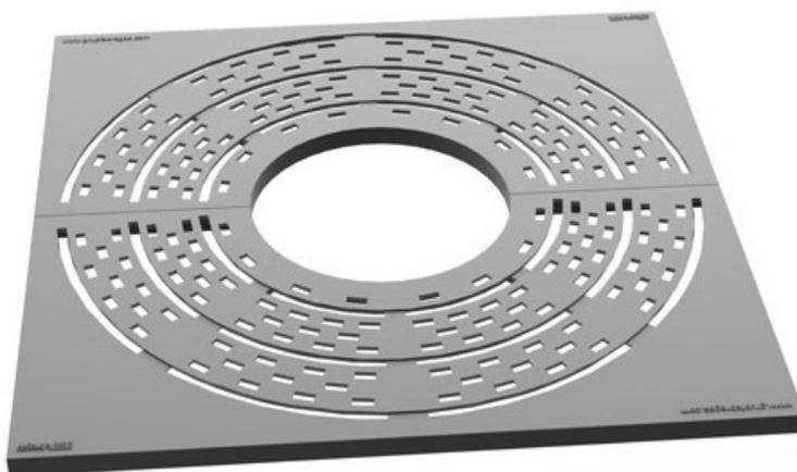
Grille d'arbre moderne conforme à la norme d'accessibilité pour les personnes à mobilité réduite. Fonte FGL 250. Finition peinture oxyron noir. 2 éléments. Dims (cm) : 100 X 100 cm. Diamètre intérieur 35 cm. Poids : 44 kg. En option, cadre acier de support de grille.
