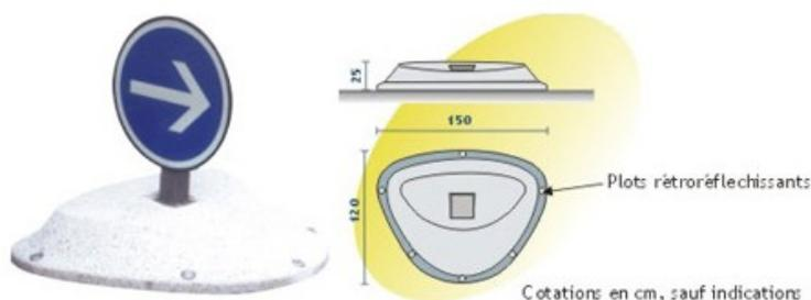
L îlot petit modèle est un élément en béton non franchissable, utilisé pour la réalisation de chicanes ou de rétrécissement de chaussée au niveau des zones 30 ou autres zones sensibles... Il peut être également utilisé en milieu de chaussée. Posé sur le sol. Il est équipé de 6 plots en verre rétro réfléchissant intégrés. Manutention : par 1 douille de levage M12 inox. Poids : 425 kg. Il peut être équipé d'une balise ou d'un panneau de signalisation en option.
