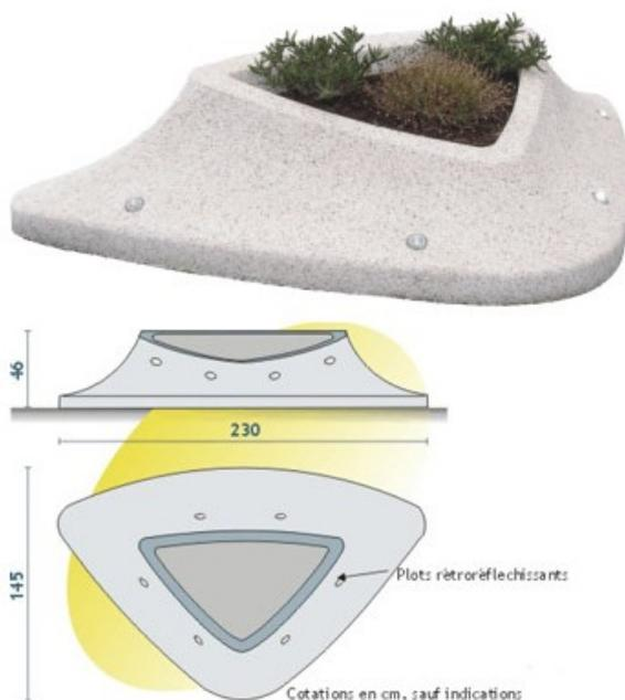
L îlot grand modèle est un élément en béton non franchissable, utilisé pour la réalisation de chicanes ou de rétrécissement de chaussée au niveau des zones 30 ou autres zones sensibles. Posé sur le sol. Il est équipé de 6 plots en verre rétro réfléchissant intégrés. Manutention : 3 crochets de manutention. Poids : 1000 kg. Il peut être fleuri et équipé d'une balise ou d'un panneau de signalisation en option.
