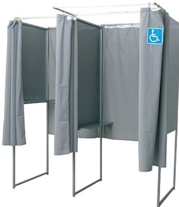
Conçu pour être installé contre un mur (une seule entrée) ou isolément (2 entrées), il peut comporter un nombre illimité de cases et recevoir en fin de groupe une case spéciale handicapés . Rideau gris en toile classée M1 avec anneaux et tringlerie. Dims d'une case (cm) : 80 X 80 , H = 200 cm. Poids d'une cloison : 12 kg.
