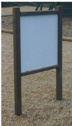
Structure en pin du nord rouge Finlande, catégorie 5, gage de stabilité et de haute résistance. Bois traité autoclave classe IV sans chrome ni arsenic. Visserie inox A2. livré monté, à sceller. Panneau double face 70 X 70 cm : panneau compact 10 mm, impression numérique en option, nous consulter.
