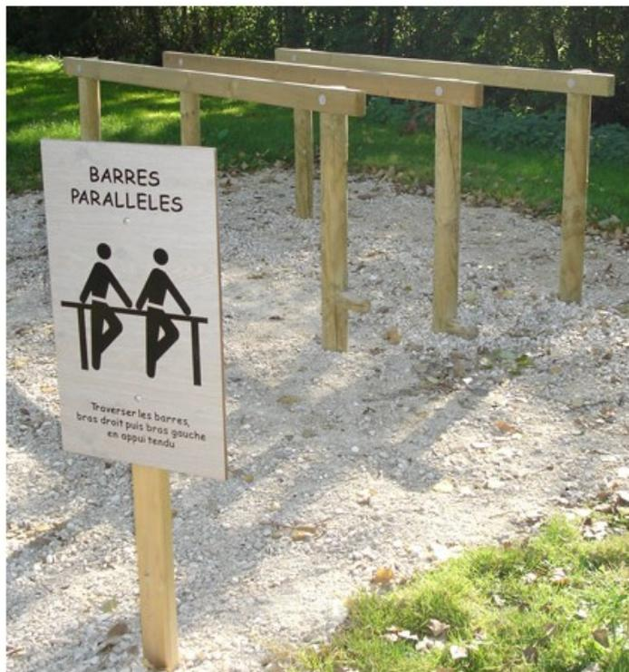
Bois pin du nord Rouge Finlande, catégorie 5, gage de stabilité et de haute résistance. Traitement autoclave classe IV, sans chrome ni arsenic. Principe de l'atelier : traverser les barres, bras droit puis bras gauche en appui tendu. Zone d'implantation : 4,2 X 5,4 m. Ensemble composé de 3 barres avec pieds poteaux rondins de diamètre 10, barres de section 9 X 4,5 cm X H hors sol 120 cm. A sceller. Livré avec panneau de consignes.
