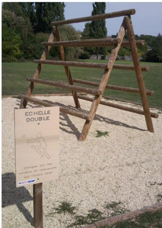
Bois pin du nord Rouge Finlande, catégorie 5, gage de stabilité et de haute résistance. Traitement autoclave classe IV, sans chrome ni arsenic. Principe de l'atelier : grimper par les rondins et descendre sur l'autre côté. Zone d'implantation : 5,6 X 4,7 m. Ensemble composé de 2 échelles face à face avec des pieds en rondin de diamètre 10 cm et des barres diamètre 8 cm X H hors sol 220 cm. A sceller. Livré avec panneau de consignes.
