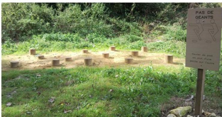
Bois pin du nord Rouge Finlande, catégorie 5, gage de stabilité et de haute résistance. Traitement autoclave classe IV, sans chrome ni arsenic. Principe de l'atelier : sauter de plot en plot d'une jambe sur l'autre. Zone d'implantation : 8 X 5 m ou 10 X 4 m. Ensemble composé de 15 rondins de diamètre 20. H hors sol 20 cm. A sceller. Livré avec panneau de consignes.
