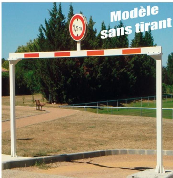
Hauteur sous lisse 2,20m. Poteaux en tube d'acier galvanisé carré de 100 X 100 X 3 mm épaisseur. Livrés avec platines de scellement de 300 X 300 X 10 mm épaisseur, percées pour la fixation au sol. Gabarit de pose fourni. Lisse en tube d'acier galvanisé de 100 X 100 X 3 mm avec bandes rétro-réfléchissantes sur les 2 faces. Finitions : Galvanisation à chaud, peinture sous-couche époxy et polyuréthane bi composant en finition avec polymérisation au four. Options : panneau limiteur de hauteur.
