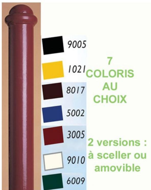
Potelet traité anti-corrosion, en acier galvanisé à chaud (+,- 80 microns). Coloration obtenue par thermolaquage (poudre polyester cuite au four), isolant et décoratif. Pivoine : Corps en tube rond diamètre 88,9 X 3,2 mm. Anneau 1,2 rond diamètre 20 mm. Dimensions : hauteur hors sol = 80 mm/ hauteur hors tout : 1130 mm. Système d'amovibilité (à sceller dans le sol) avec verrouillage par clé pompier inclus.
