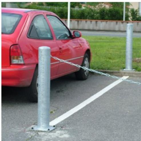
Tube acier équipé d'un chapeau bombé soudé. Ensemble galvanisé à chaud 70 microns. Soudures exécutées sur toutes les faces du produit, meulées et poncées. Options : fourreaux simples H 30 cm, fourreaux à fermeture à clé triangulaire, anneau à souder pour accrochage chaîne, chaîne zinguée ou maille rapide, bande rétro-réfléchissantes rouges. Dims (en cm) : Ø 60, ép 2, H 140, H sol 120.
