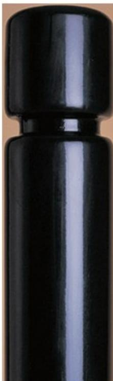
Robustes, esthétiques et fonctionnels, ces potelets sont traités anti-corrosion, en acier galvanisé à chaud (+,- 80 microns). La coloration est obtenue par thermolaquage (poudre polyester cuite au four), isolant et décoratif. Version amovible. Dims : diamètre 101,6 mm X hauteur hors sol 120 cm.
